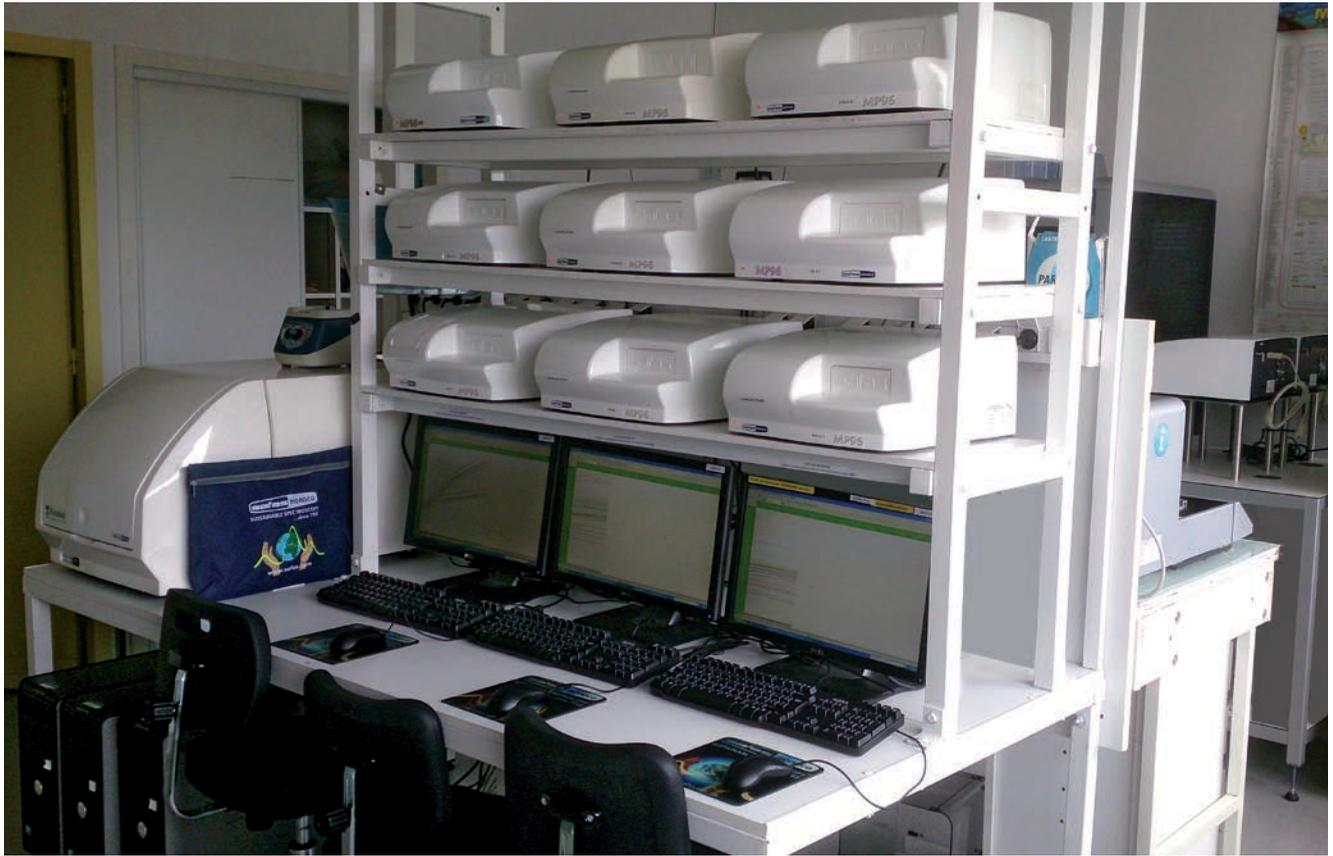
Plateforme robotisée exploitant 12 lecteurs de microplaques ultra rapides SAFAS avec pilotage innovant par Web service.
